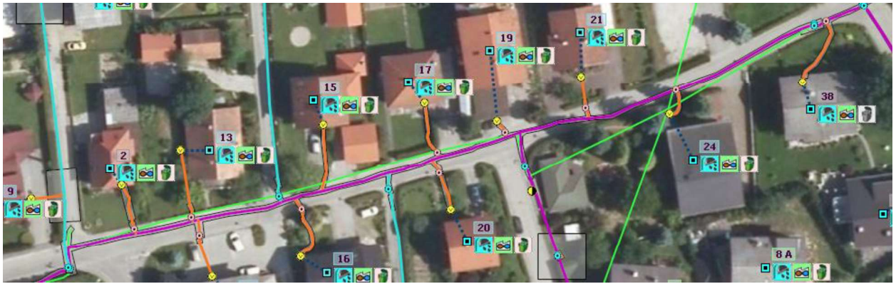
Slika 9: Obnova vodovoda Obrtna ulica (Protok)
