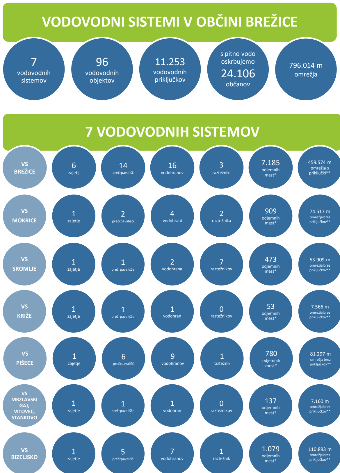
Shema 4: Vodovodni sistem v občini Brežice v številkah
